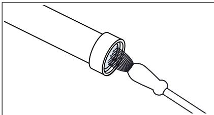
3. Schlauch anschließen und auf Dichtheit prüfen.
