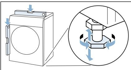
3. Kontermuttern mit einem Schraubenschlüssel SW17 handfest gegen das Gehäuse festziehen. Den Fuß dabei festhalten und in der Höhe nicht verstellen.
