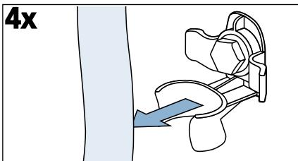
2. Alle 4 Schrauben der Transportsicherungen mit einem Schraubenschlüssel SW13 lösen und entfernen.
