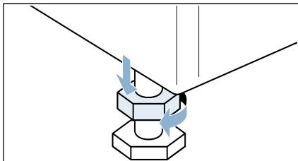
2. Gerät durch Drehen der Gerätetüfe ausrichten. Ausrichtung mit Wasserwaage überprüfen.
