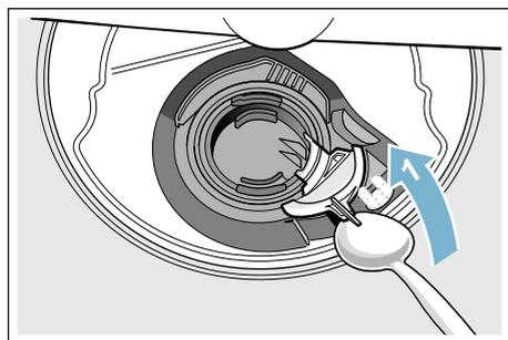
6. Vérifiez si la roue à aubes présente des corps étrangers et retirez-les le cas échéant.
