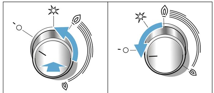
Il dispositivo di sicurezza per l'accensione è attivato. Se la fiamma si spegne, l'alimentazione di gas viene automaticamente interrotta dal dispositivo di sicurezza per l'accensione.
