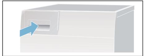
**Avvertenza:** Il filtro nel contenitore dell'acqua di condensa filtra l'acqua di condensa che viene utilizzata per la pulizia automatica dell'asciugatrice. Svuotando l'acqua di condensa il filtro viene pulito. Ciononostante controllare regolarmente che non ci siano depositi di impurità nel filtro. In caso contrario, rimuoverli. Vedere → *Pagina 37.*
