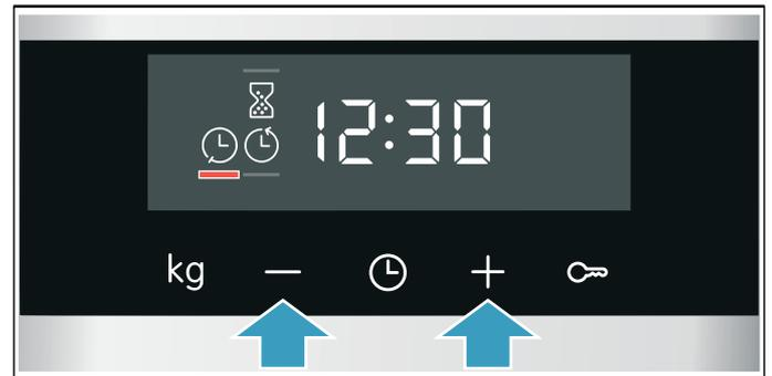
Au bout de quelques secondes, l'appareil valide les réglages. L'heure de la fin apparaît dans l'affichage. Dès que l'appareil démarre, la durée s'écoule.
