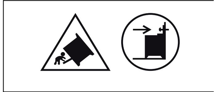
**Avvertenza:** per evitare il ribaltamento dell'apparecchio occorre montare una protezione antiribaltamento. Leggere le istruzioni di montaggio.
