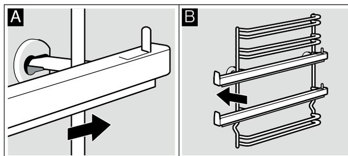
Les supports s'adaptent uniquement à droite ou à gauche. Veillez à ce que la hauteur 1 et 2 soit en bas, comme sur la fig. B, et la hauteur 3, 4 et 5 en haut. Les rails de défournement doivent pouvoir être tirés vers l'avant.
