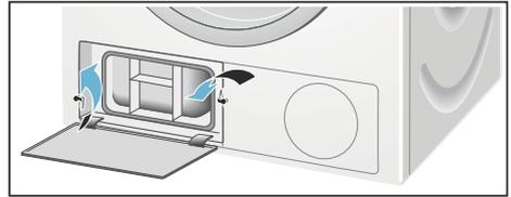
4. Снимите верхнюю крышку теплообменника.
