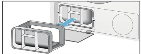
5. Entnehmen Sie den Wärmetauscher.
