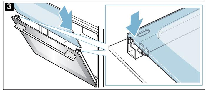
5. Abdeckung aufsetzen und andrücken bis sie hörbar einrastet (Bild 4).
