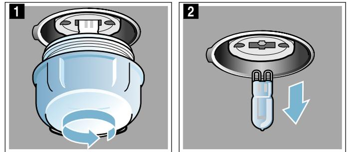
4. Glasabdeckung wieder einschrauben. Je nach Gerätetyp ist die Glasabdeckung mit einem Dichtring ausgestattet. Dichtring vor dem Einschrauben wieder aufsetzen.
