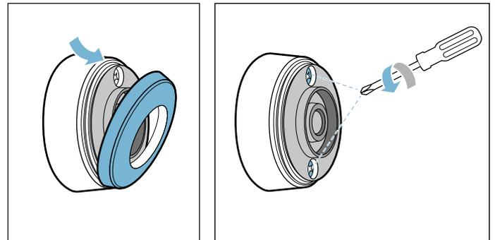
2. Abrir la tapa del Sensor de cocción. Retirar la batería del interior de la base y colocar la nueva batería (seguir las instrucciones de polaridad de la batería).
