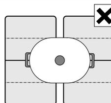
Sur les tables de cuisson possédant plus d'une zone de cuisson flexible, placez le récipient sur la table de cuisson de telle manière qu'il ne recouvre qu'une seule zone de cuisson flexible. Sinon les foyers ne seront pas correctement activés et il ne sera pas possible d'obtenir un bon résultat de cuisson.
