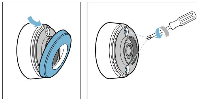
2. Ouvrez le bouchon de la sonde de température. Retirez la pile de la partie inférieure du boîtier, puis insérez une nouvelle pile (veillez au sens correct des pôles de la pile).
