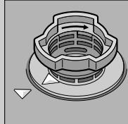
Kierrä siiviläjärjestelmä kiinni! **HUOMIOI MERKIT!**
