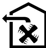
Usisani zrak čisti se prolaskom kroz filter za masnoću te se kroz cjevovod odvodi na otvoreno.
