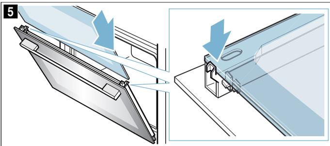
6. Abdeckung aufsetzen und andrücken bis sie hörbar einrastet (Bild 6).
