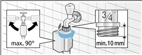
**Remarque :** Ouvrez prudemment le robinet d'eau tout en vérifiant si les raccords sont étanches. La jonction par vis se trouve sous la pression régnant dans la conduite d'eau.
