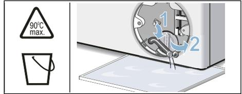
5. Dévisser délicatement le bouchon de la pompe, de l'eau résiduelle peut s'écouler. Nettoyer le compartiment intérieur, le filetage du couvercle de pompe et le carter de pompe. Le rotor de la pompe de vidange doit pouvoir tourner librement. Remettre le couvercle en place et le visser. La poignée doit se trouver à la verticale.
