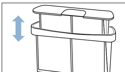
**Napomena:** Filter u sakupljaču kondenzata filtrira kondenzat koji se koristi za automatsko čišćenje vašeg uređaja. Filter se čisti pražnjenjem kondenzata. Usprkos tome redovito provjerite ima li zaostalih taloga i po potrebi ih uklonite.
