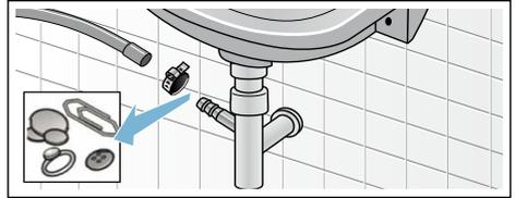
4. Rebrancher le tuyau d'évacuation et sécuriser le point de raccordement à l'aide du collier du flexible.
