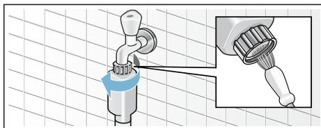
2. Nei modelli Standard e Aqua-Secure pulire il filtro nella parte posteriore dell'apparecchio: Svitare il tubo flessibile dal lato posteriore dell'apparecchio, Estrarre il filtro con la pinza e lavarlo.
