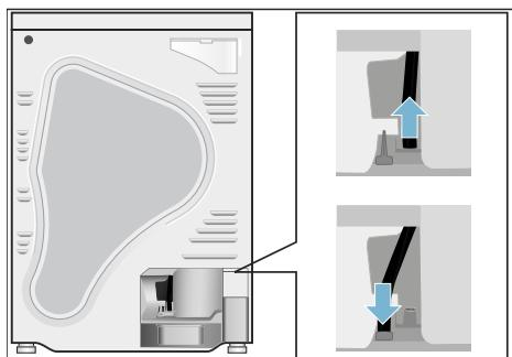
4. Nehmen Sie den Ablauchschlauch aus dem Zubehör und befestigen diesen am leeren Stutzen.
