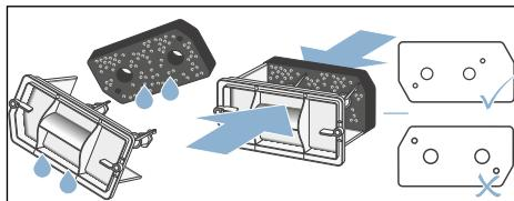
**Hinweis:** Achten Sie darauf, dass die Filtermatte nicht verformt, gerissen oder verstopft ist. Positionieren Sie die Filtermatte wie oben abgebildet.
