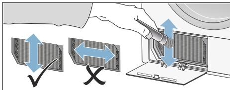
**Hinweis:** Achten Sie beim Reinigen darauf, dass Sie die Lamellen des Wärmetauschers nicht verbiegen oder beschädigen.
