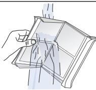
7. Trocknen Sie die Flusensiebe ab, klappen diese zu und setzen das zweiteilige Flusensieb wieder ein.
