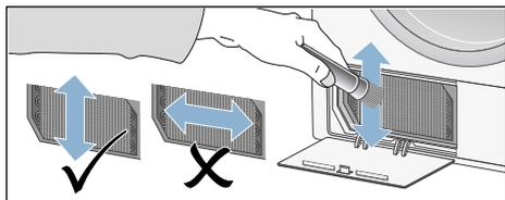
**Remarque :** Lors du nettoyage, veiller à ne pas plier ou endommager les lamelles de l'échangeur thermique.
