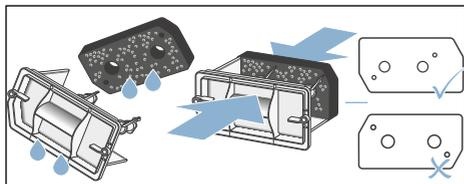
**Remarque :** Veiller à ce que la natte filtrante ne soit pas déformée, ni déchirée ou obstruée. Positionner la natte filtrante comme l'indique la figure en haut.
