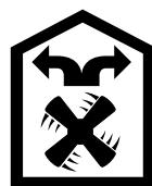
Втягнуте витяжкою повітря очищається, проходячи через жировловлювальний та вугільний фільтр, і повертається потім до кухні.
