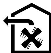
Втягнуте витяжкою повітря очищується, проходячи через жиропоглинаючі фільтри, і виходить назовні з будинку по системі труб.
