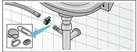
4. Ablaufschlauch wieder aufstecken und Anschluss mit Schlauchschelle sichern.
