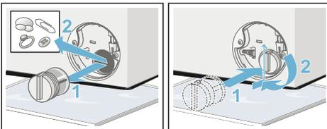
6. Service-Klappe einsetzen, einrasten und schließen.
