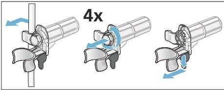
3. Abdeckungen einsetzen. Abdeckungen fest verriegeln durch Druck auf den Rasthaken.
