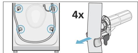
2. Netzleitung aus den Halterungen nehmen. Alle 4 Transportsicherungsschrauben lösen und entfernen. Hülsen entfernen.
