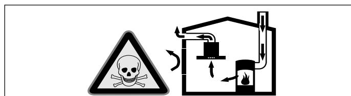
Los equipos calefactores que dependen del aire del recinto de instalación (p. ej., calefactores de gas, aceite, madera o carbón, calentadores de salida libre, calentadores de agua) adquieren aire de combustión del recinto de instalación y evacuan los gases de escape al exterior a través de un sistema extractor (p. ej., una chimenea).
