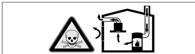
Los equipos calefactores que dependen del aire del recinto de instalación (p. ej., calefactores de gas, aceite, madera o carbón, calentadores de salida libre, calentadores de agua) adquieren aire de combustión del recinto de instalación y evacuan los gases de escape al exterior a través de un sistema extractor (p. ej., una chimenea).
