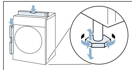
3. Falls notwendig, Gerät neu ausrichten durch Drehen der Gerätefüße. Sie können das Gerät jetzt anschließen.
