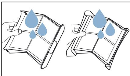
8. Flusensiebe abtrocknen, zuklappen und wieder einsetzen.
