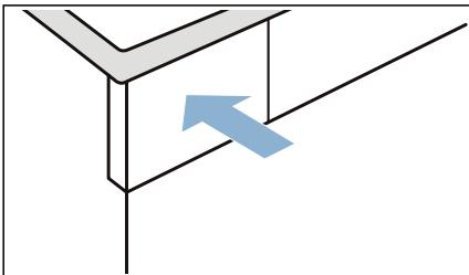
**Hinweis:** Das Sieb im Kondenswasser-Behälter filtert das Kondenswasser, das zur automatischen Reinigung Ihres Geräts verwendet wird. Das Sieb wird durch Entleeren des Kondenswassers gereinigt. Prüfen Sie das Sieb trotzdem regelmäßig auf verbliebene Ablagerungen und ggf. entfernen Sie diese.
