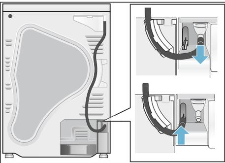
4. Nehmen Sie den Ablaufschlauch aus dem Zubehör und befestigen diesen am leeren Stutzen.
