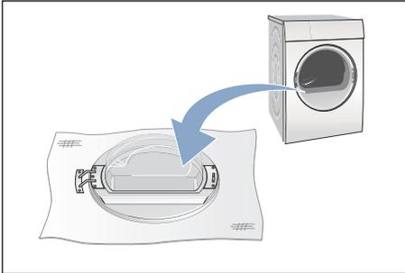
4. Entfernen Sie jetzt die Schrauben vom Türgelenk und nehmen dieses von der Trocknertür ab.
