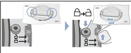
7. Heben Sie jetzt die Trocknertür vom Türring ab. Drehen Sie die Trocknertür und setzen diese wieder passend auf den Türring.
