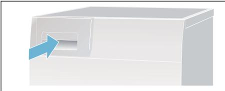
**Hinweis:** Das Sieb im Kondenswasser-Behälter filtert das Kondenswasser, das zur automatischen Reinigung Ihres Trockners verwendet wird. Das Sieb wird durch Entleeren des Kondenswassers gereinigt. Prüfen Sie das Sieb trotzdem regelmäßig auf verbliebene Ablagerungen und entfernen diese. Siehe → Seite 34.
