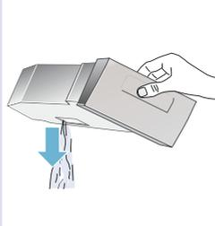
Vaciar el recipiente para agua condensada.
