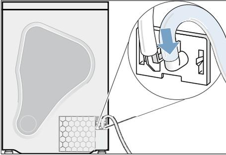
6. Fijar el otro extremo de la manguera de desagüe con el resto de accesorios en función del caso de conexión (A, B o C).
