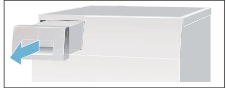
2. Vaciar el agua condensada.
