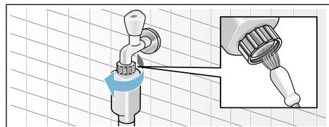
6. Nos modelos Standard e Aqua-Secure, limpar o filtro na parte traseira do aparelho:
