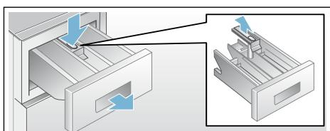
3. Lavar e secar bem a gaveta do detergente e o dispositivo da gaveta com água e uma escova. Lavar também o interior da estrutura.
