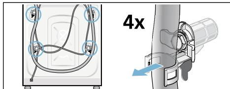
2. Soltar e remover os 4 parafusos dos dispositivos de segurança para transporte.
