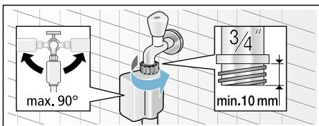
**Conselho:** Abrir com cuidado a torneira da água e verificar a estanqueidade dos pontos de ligação. A união rosada está sob pressão do sistema de abastecimento de água.
