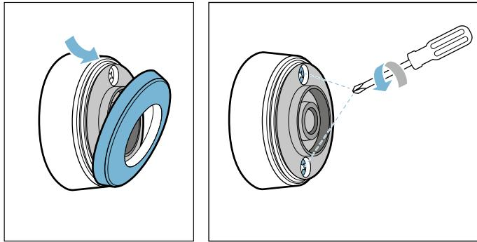
2. Åpne dekselet til temperatursensoren. Ta batteriet ut av underdelen av huset, og sett inn et nytt batteri (pass på at pluss- og minuspolen vender riktig vei).
