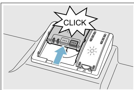
Le compartiment à détergent s'ouvre automatiquement au moment optimal, en fonction du programme. Le détergent en poudre ou liquide se répartit dans l'appareil et se dissout, la pastille tombe dans la coupelle interceptrice de pastille et s'y dissout de façon dosée.
