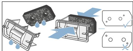
**Hinweis:** Achten Sie darauf, dass die Filtermatte nicht verformt, gerissen oder verstopt ist. Positionieren Sie die Filtermatte wie oben abgebildet.
