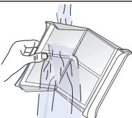
7. Trocknen Sie die Flusensiebe ab, klappen diese zu und setzen das zweiteilige Flusensieb wieder ein.
