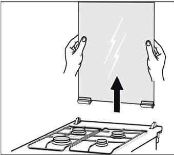
Si les charnières du couvercle se détachent, repérez les lettres qui se trouvent dessus. La charnière marquée de la lettre R doit être montée à droite, la charnière avec la lettre L à gauche.
