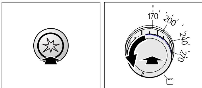
5. Le gaz qui s'échappe du brûleur inférieur du four est enflammé au moyen du bouton d'allumage. Afin que la sécurité d'allumage soit opérationnelle, maintenez le commutateur du brûleur à gaz inférieur enfoncé pendant 10 secondes.
