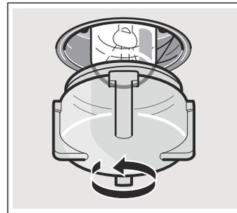
3. Remplacer l'ampoule par un modèle identique.
