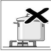
Le plat doit systématiquement être placé au milieu de la plaque, sinon il risque de se renverser.
