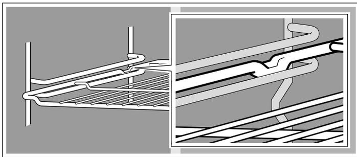
**Remarque :** L'accessoire peut se déformer sous l'effet de la chaleur. Une fois refroidi, l'accessoire reprend sa forme initiale. Cela n'a pas d'incidence sur son fonctionnement.
