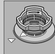
Kierrä siiviläjärjestelmä kiinni HUOMIO! MERKIT!
