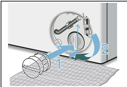
8. Service-Klappe einsetzen und einrasten.
