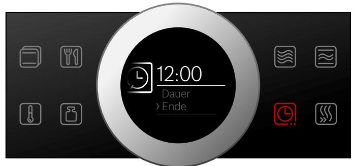
Nach wenigen Sekunden wird der Wert übernommen oder erneut auf Feld tippen. Im Display steht unter Betriebsart und Temperatur oder Stufe die Endezeit.
