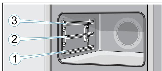
In den Einschubhöhen 1, 2, und 3 das Zubehör immer zwischen die beiden Führungsräume einer Einschuhshöhe schieben.
