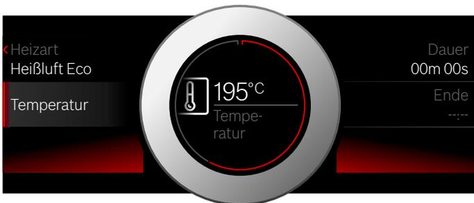
3. Mit Taste start/stop  $\triangleright$  starten. Die Zeit im Display zeigt an, wie lange der Betrieb bereits läuft.
