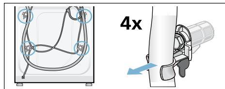
2. Alle 4 Transportsicherungsschrauben mit einem Schraubenschlüssel SW13 lösen und entfernen.
