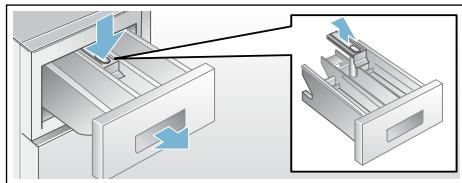
3. Einspülsschale und Einsatz mit Wasser und Bürste reinigen und abtrocknen. Auch Gehäuse innen reinigen.
