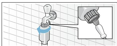
2. Bei Modellen Standard und Aqua-Secure Sieb an der Geräterückseite reinigen:
