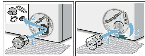
6. Service-Klappe einsetzen, einrasten und schließen.
