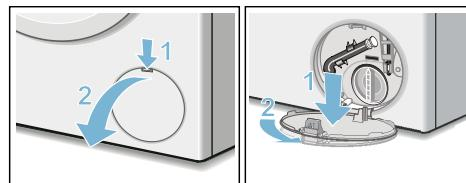
4. Entleerungsschlauch aus der Halterung nehmen. Verschlusskappe abziehen, Lauge in geeignetes Gefäß abfließen lassen. Verschlusskappe aufdrücken und Entleerungsschlauch in die Halterung einsetzen.
