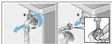
3. Schlauch anschließen und auf Dichtheit prüfen.
