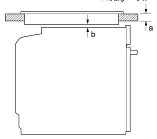
نوع الموقد ثابت مستو مع الأسطح 5 مم 37 مم 38 مم موقد حثي موقد حثي للتركيب على 5 مم 48 مم 43 مم السطح بأكمله 5 مم 42 مم 32 مم موقد غازي 2 مم 24 مم 22 مم موقد كهربائي
