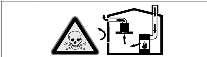
Grijala na plamen koja ovise o zraku iz prostorije (npr. plinska grijala, grijala na ulje i drva ili ugljen, protočni grijači vode, uređaji za pripremu tople vode) troše zrak za sagorijevanje iz prostorije u kojoj je postavljen uređaj i odvođe dimne plinove kroz dimovodne uređaje (npr. dimnjak) na otvoreno.
