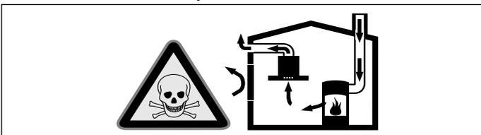
Зависимите от стайния въздух печки (напр. нагревателните уреди, работещи с газ, нафта, дърва или въглища, конвекторните нагреватели, калориферите) изтеглят въздух за изгаряне от мястото на поставяне и изкарват отработени газове през съоръжение за отработени газове (напр. дымоотвод) на открито. При включен абсорбатор се изкарва въздуха от кухнята и съседните помещения - ако няма достатъчен приток на въздух
