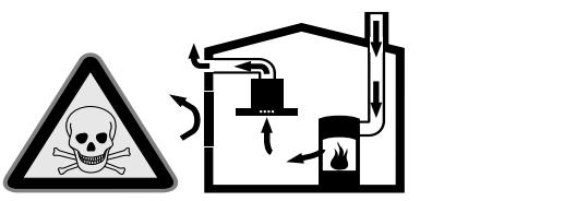
Εστίες, εξαρτημένες από τον αέρα του περιβάλλοντος (π.χ. συσκευές θέρμανσης που λειτουργούν με αέριο, πετρέλαιο, ξύλο ή άνθρακα, ταχυθερμοσίφωνες, θερμαντήρες νερού) λαμβάνουν τον αέρα για καύση από το χώρο τοποθέτησης και σδηγούν τα καυσαέρια μέσα από μια εγκατάσταση απαγωγής των καυσαερίων (π.χ. καμινάδα) στον έξω χώρο.
