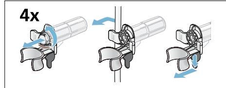
3. 洗衣機隨附的小零件中包含四個塑膠蓋，將這些蓋子分開，並在移除運輸螺栓後安裝在每個螺栓中。按壓彈簧鉤安裝蓋板。將蓋子鎖牢。
