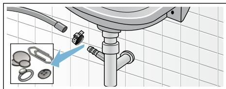
5. 重新連接排水管並以金屬管夾加以固定。
