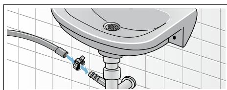
■ **將水排至有橡膠套管的塑膠管或水槽中**
