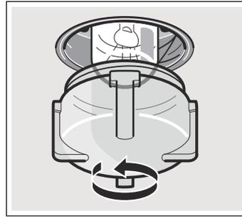
3. Remplacer l'ampoule par un modèle identique.
