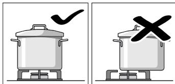
Le plat doit systématiquement être placé au milieu de la plaque, sinon il risque de se renverser.
