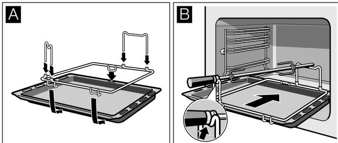
3. Insérez la plaque de cuisson sur le niveau 1. La paroi arrière du four comporte une ouverture. Engagez le tournebroche à cet emplacement (Figure C).
