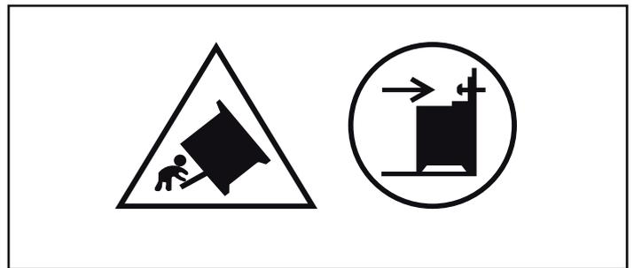
**Avertissement :** Afin d'éviter un basculement de l'appareil, il convient de mettre en place une protection anti-renversement. Veuillez lire la notice de montage.
