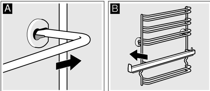
Les supports s'adaptent uniquement à droite ou à gauche. Veillez à ce que la hauteur 1 et 2 soit en bas, comme sur la fig. B, et la hauteur 3, 4 et 5 en haut. Le rail de défournement doit pouvoir être tiré vers l'avant.
