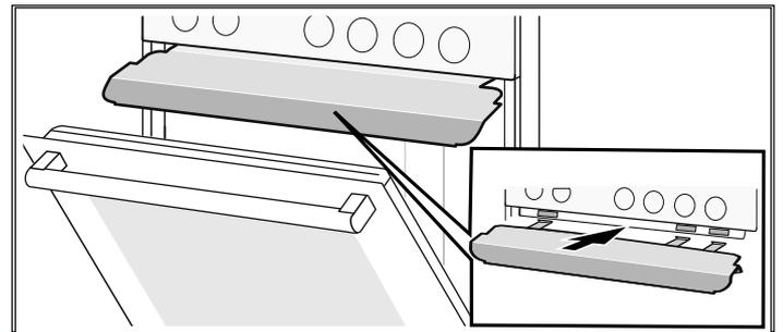
Fixez la tôle protectrice avec les fixations dans la rainure située en-dessous du bandeau de commande.
