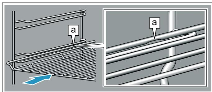
Ao inserir a grelha, certifique-se de que o entalhe **a** se encontra atrás e de que está virado para baixo. A frente da chanfradura do acessório **b** deve estar virada para a porta do aparelho.
