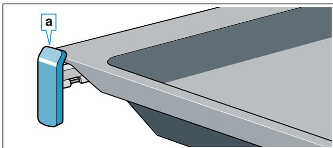
As calhas extensíveis encaixam quando estiverem totalmente extraídas. Desta forma, coloca-se facilmente o acessório. Para desencaixar as calhas extensíveis, empurre-as para o interior do aparelho exercendo alguma pressão.
