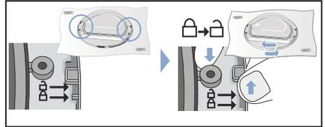
7. Heben Sie jetzt die Trocknertür vom Türriegel ab. Drehen Sie die Trocknertür und setzen diese wieder passend auf den Türriegel.
