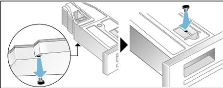
8. Ziehen Sie den Filter aus der Rastung und setzen Sie diesen in die Vertiefung des Kondenswasserbehälters.
