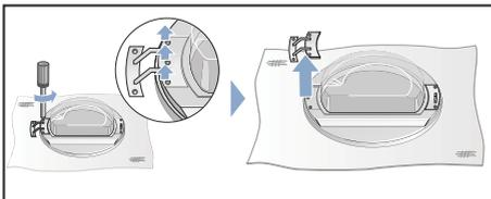
5. Entfernen Sie die Schrauben vom Türgriff der Trocknertür und nehmen diesen ab.
