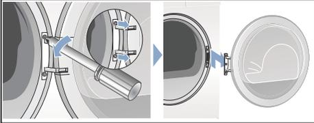
3. Legen Sie die Trocknertür vorsichtig auf einen flachen Untergrund und legen z.B. ein Handtuch unter, um die Tür nicht zu zerkratzen oder zu beschädigen.
