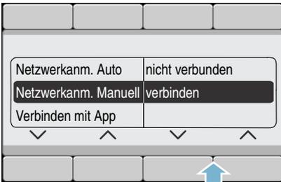
Das Gerät richtet jetzt ein eigenes WLAN Netzwerk mit dem Netzwerknamen (SSID) **HomeConnect** ein, auf das Sie mit Ihrem Smartphone oder Tablet PC zugreifen können.
