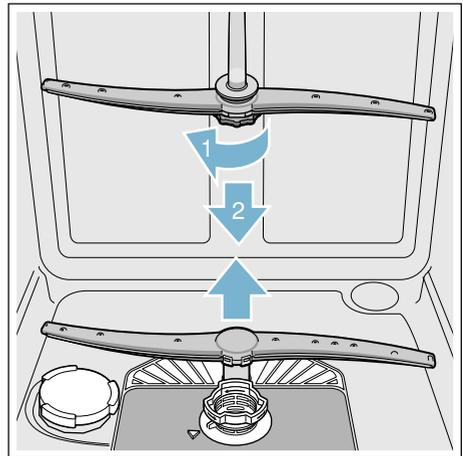
4. Sprüharme unter fließendem Wasser reinigen.
