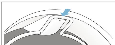
Корзина для сушки шерсти зафиксирована в барабане сушильной машины.
