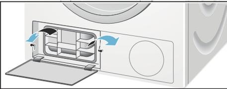
11. Закройте дверцу для технического обслуживания до фиксации со щелчком.
