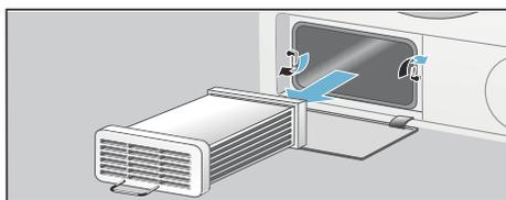
6. Промойте теплообменник со всех сторон под струёй воды, чтобы полностью удалить все ворсинки.
