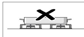
Не използвайте две горелки или два източника на топлина за един съд за готвене.
