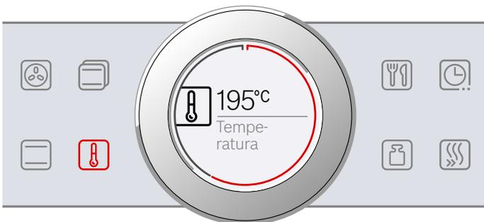
4. Iniciar con la tecla «start/stop» ▷. El tiempo de pantalla muestra el tiempo transcurrido de funcionamiento.
