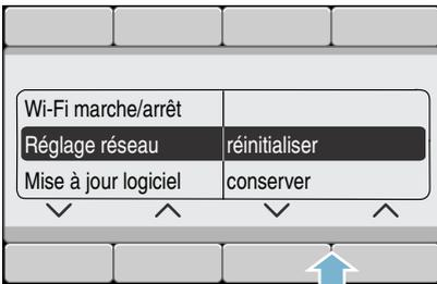
5. Sélectionnez, à l'aide de l'une des deux flèches de droite, **Continuer**. Les paramètres réseau sont à présent réinitialisés. Votre appareil n'est plus connecté au réseau domestique ni à l'appli Home Connect.
