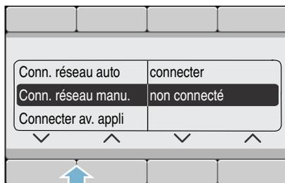
4. Sélectionnez, à l'aide de l'une des deux flèches de droite, **connecter**.
